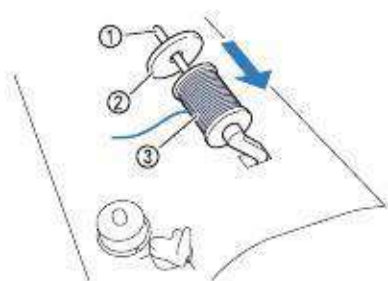
a Ax bobina b Flansa bobinei c Mosor/papiota cu ata
