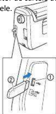
a Port USB pentru mouse/stick b Stick USB
