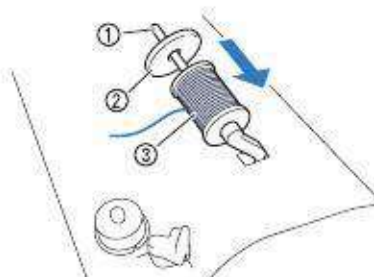
a Ax b Flansa bobina c Ata mosorel
