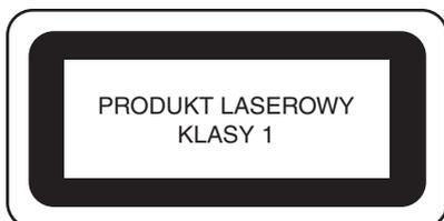
Moc wyjściowa wiązki laserowej emitowanej przez laser zainstalowany w maszynie jest ograniczona do bezpiecznego poziomu. Jednak maszyna posiada moc 6-miliwatów, emituje fale o długości 630-640 nanometrów; równoległy kąt rozbieżności wynosi 6-12, prostopadły kąt rozbieżności wynosi 28-40 stopni; zastosowano diody laserowe InGaAlP. Dlatego w wyniku demontażu lub modyfikacji maszyny może dojść do obrażeń oczu.
