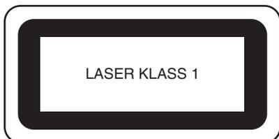
Laserstrålen som avges av den laserenhet som är installerad i denna maskin är begränsad till en uteffekt på en säker nivå. Maskinen innehåller dock 6 milliwatt, 630-640 nanometervåglängd, 6-12 grader vid parallell divergensvinkel, 28-40 grader vid vinkelrät divergensvinkel, InGaAlP-laserdioder. Därför kan ögonskador orsakas av demontering eller förändring av maskinen.
