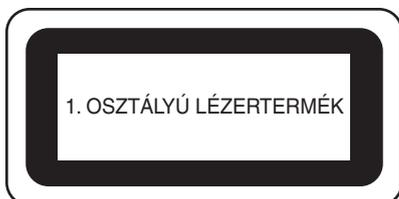
A gépbe beépített lézeregység által kibocsátott lézersugár egy biztonságos szintű kimenetre korlátozódik. A gép azonban 6 milliwattos, 630-640 nanométeres hullámhosszúságú, 6-12 fokalos InGaAlP lézer diódákat tartalmaz párhuzamos divergencia szögű, illetve 28-40 fokalos diódákat merőleges divergencia szög esetén. Szétszerelés vagy a gép módosítása esetén ezért szemsérülés fordulhat elő.
