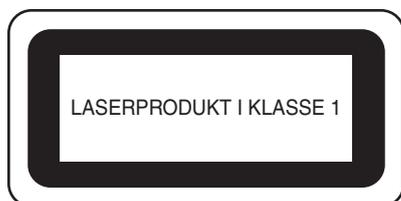
Laserstrålen, der udsendes af laserenheden i denne maskine, er begrænset til et output på et sikkert niveau. Maskinen indeholder dog InGaAlP laserdioder på 6 milliwatt, 630-640 nanometer bølglængde, 6-12 grader ved parallel divergensvinkel, 28-40 grader ved vinkelret divergensvinkel. Der kan derfor opstå øjenskader ved adskillelse eller modificering af denne maskine.
